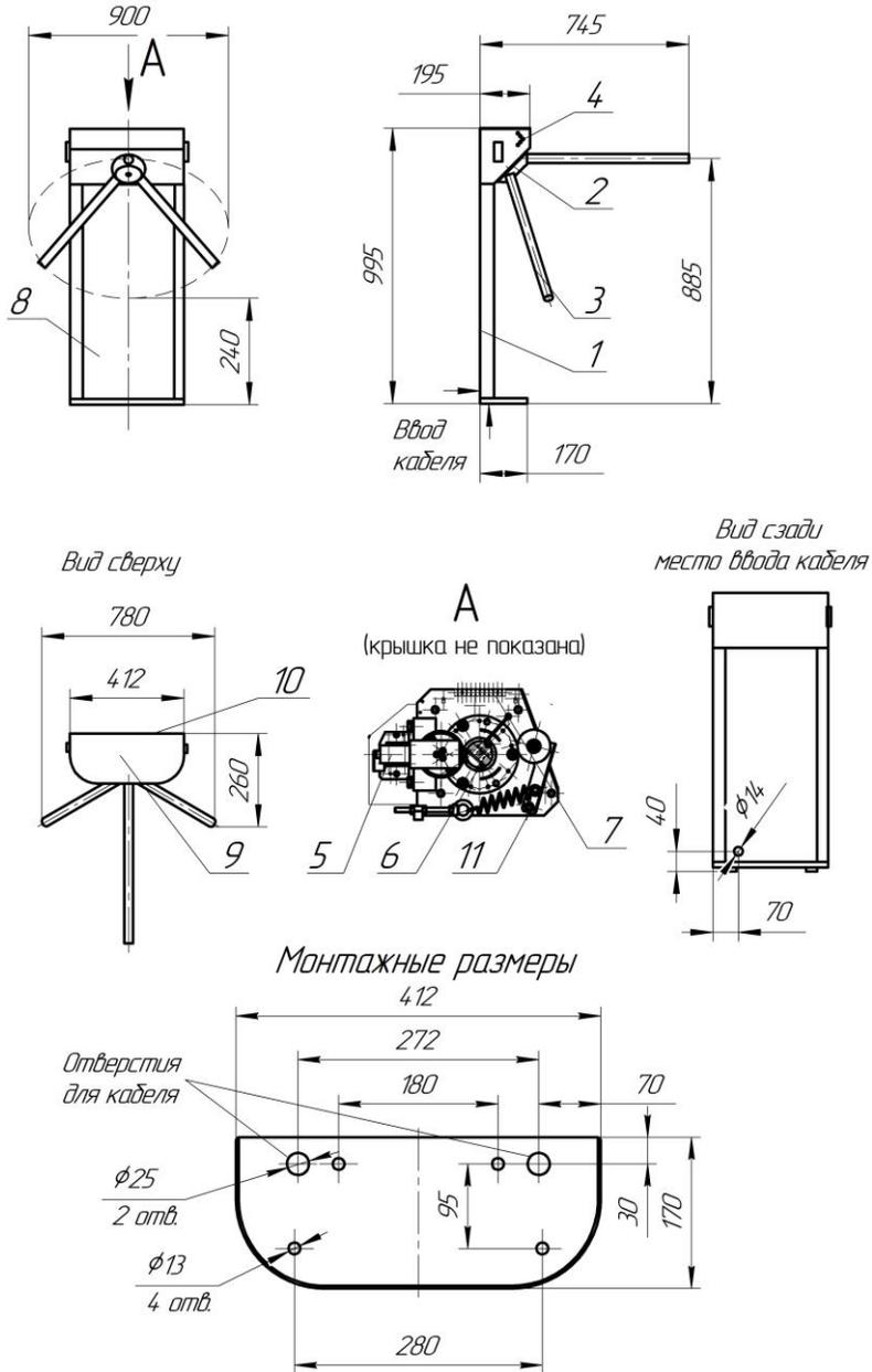
Габаритные и установочные размеры АП «Ростов-Дон Т83М1 STEP10 Штрихкод»
