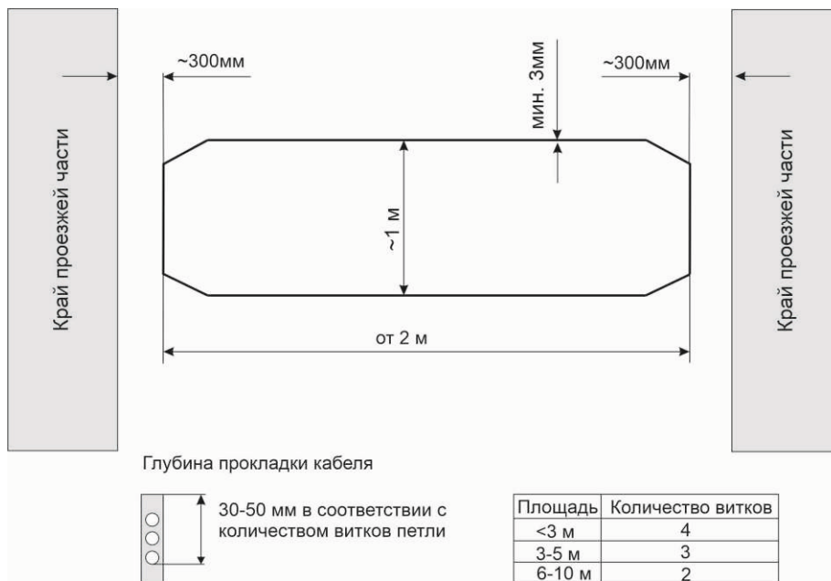
Рисунок 6.9.2.2 Схема монтажа петли
