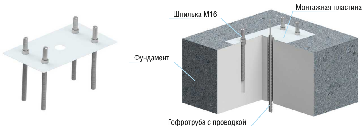
Рисунок 7.2.1 Устройство фундамента с монтажным комплектом
