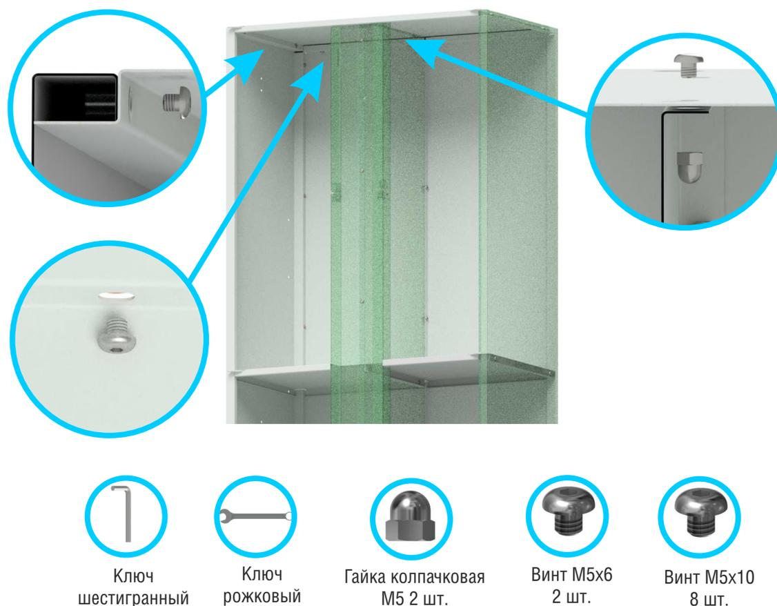
Рисунок 6.1.8 Установка верхней крышки
