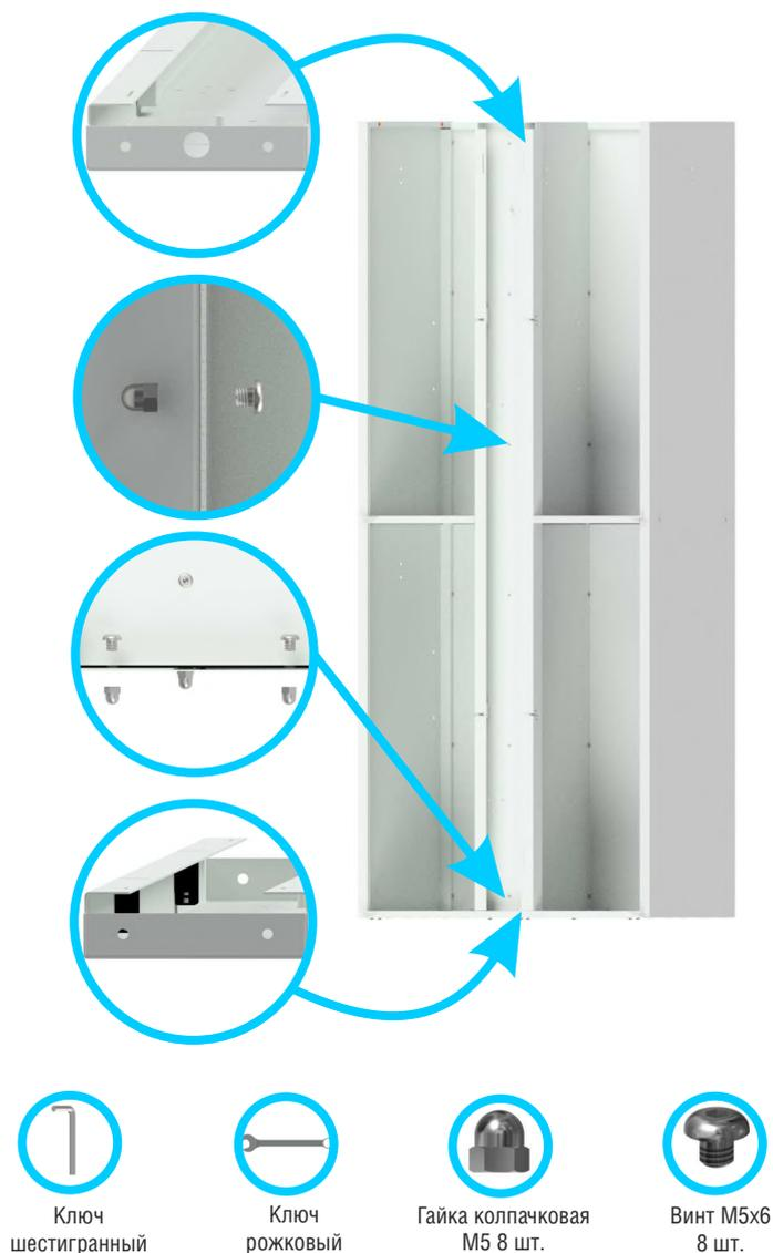
Рисунок 6.1.7 Монтаж задней части центральной панели
