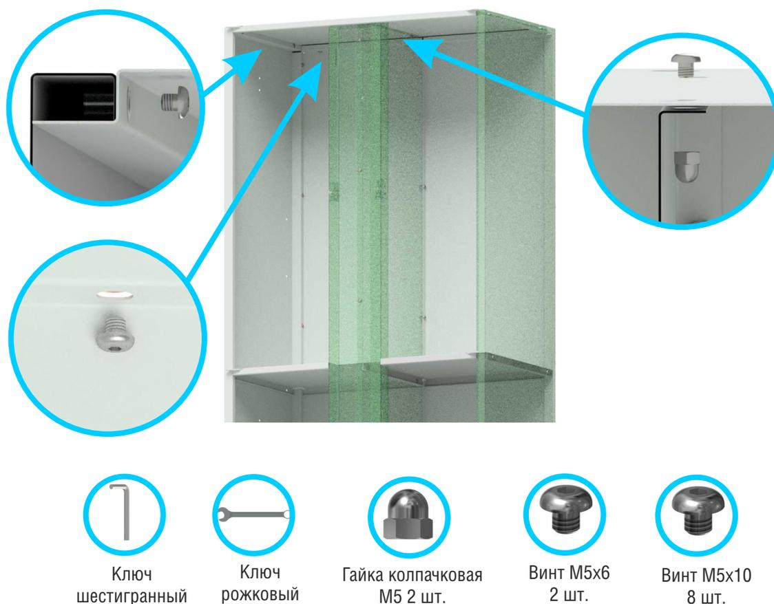
Рисунок 6.1.8 Установка верхней крышки
