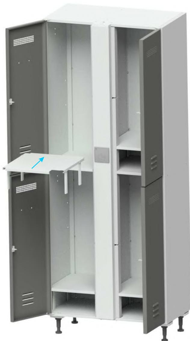
Рисунок 6.1.16 Установка полок ячейки
