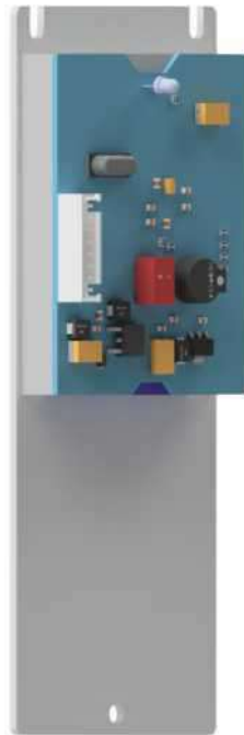
Рисунок 6.3.2 Внешний вид бесконтактного считывателя карт формата Mifare
