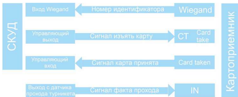
Рисунок 6.2.1 Алгоритм работы картоприемника
