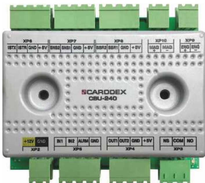
Рисунок 6.3.1 Контроллер управления турникетом «CBU-240»
