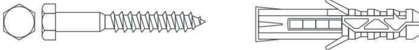
Рисунок 7.4.1 – Шуруп с шестигранной головкой «Глухарь» с дюбелем
