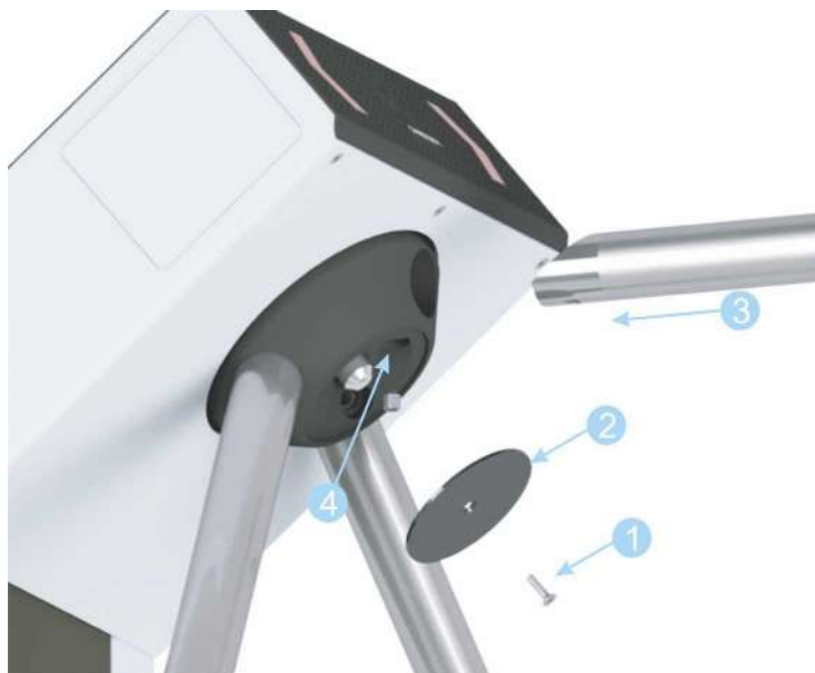
Рисунок 7.5.1 - Установка стандартной преграждающей планки
